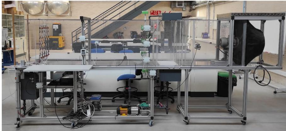
Figura 2. Esquema hidráulico (Arriba izquierda) y fotografía de una configuración de parrilla de 5 x 5 atomizadores ultrasónicos (Arriba derecha). Túnel de viento subsónico en el que se ha desarrollado el trabajo experimental (Abajo). Martínez et al. (IHCT-17 2023)
