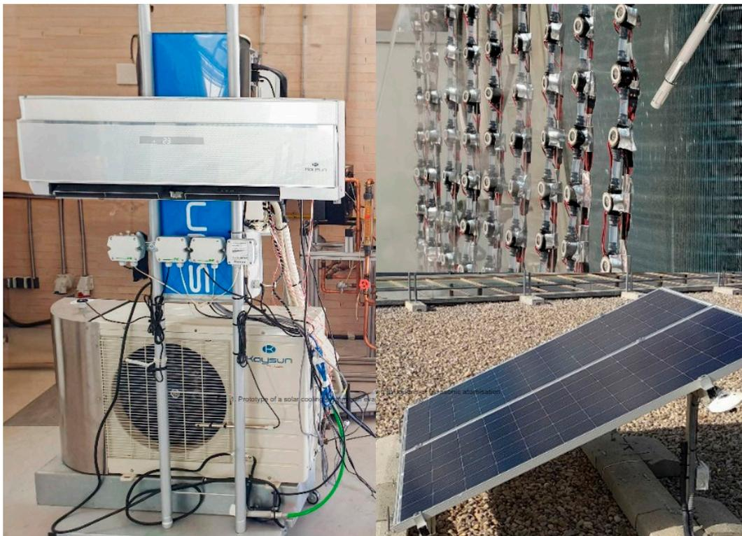
Figura 3. Fotografías del prototipo de equipo de aire acondicionado tipo Split accionado simultáneamente por paneles fotovoltaicos y red con reenfriamiento evaporativo mediante atomización ultrasónica. Martínez et al. (CNIT 2023)
