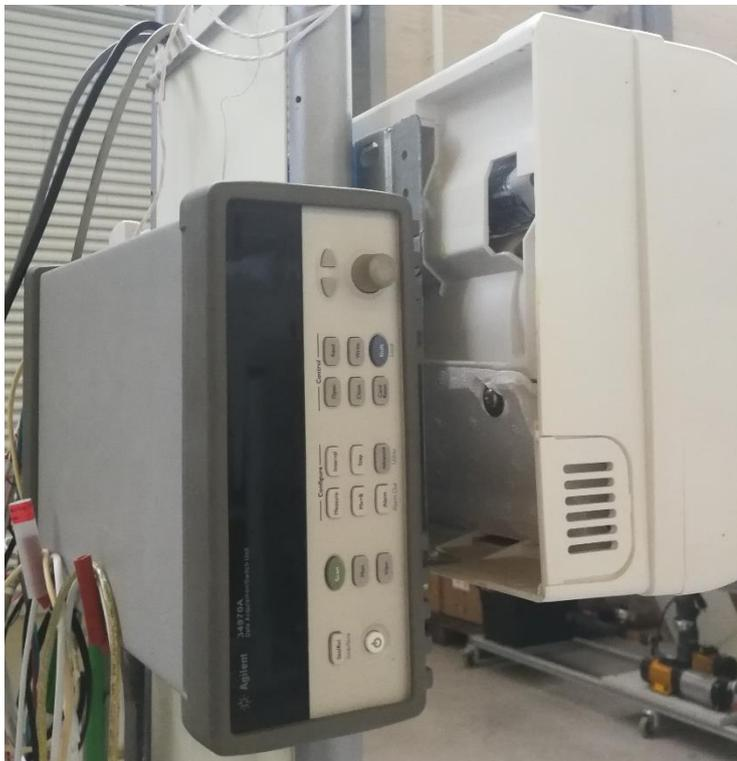
Ilustración 48 DataLogger Agilent 34970 de los ensayos
