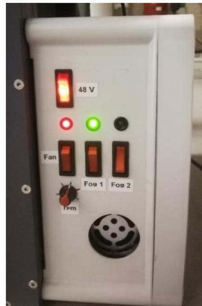
*Ilustración 33 Sistema de activación del Nebulizador y regulación de su velocidad.*
