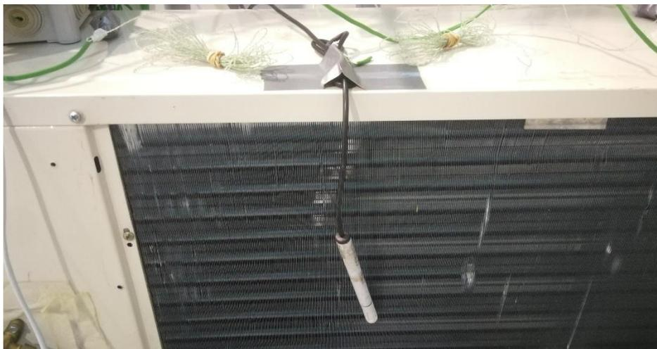
*Ilustración 40 Termo-higrómetro 23*
