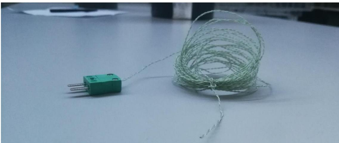
*Ilustración 38 TermoPar tipo k*
