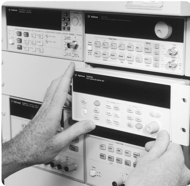
*Sistema de conmutación de bajo coste para pruebas automatizadas*
