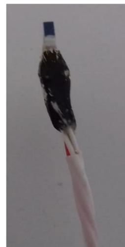
*Ilustración 41 RTD Pt100 de los ensayos*
