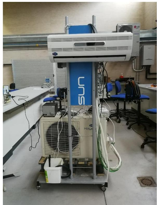
*Ilustración 26 Ciclo Refrigerador Real Cara del Evaporador*
