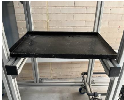
Figura 3.07 Bandeja para alojar la unidad de adquisición de datos.
