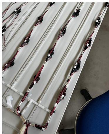
Figura 2. 27 Disposición de los cables sobre la parrilla.
