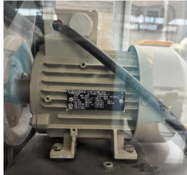
Figura 3.05 Motor eléctrico acoplado al ventilador.
