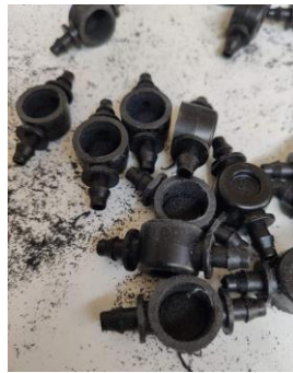
Figura 2.17 Mini válvula tras el proceso de limado para aumento de superficie de pegado.
