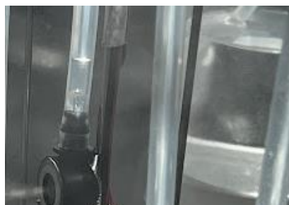
Figura 2.14 Vista en detalle de la formación de burbujas de aire en la instalación.
