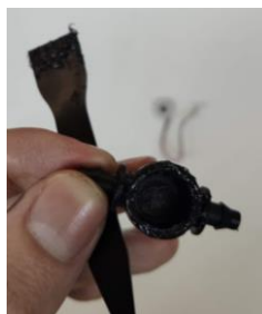
Figura 2.18 Fijación adhesiva del atomizador sobre la mini válvula a modo de cuerpo de suministro.
