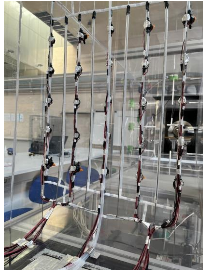
Figura 2.23. Vista general del prototipo y uso de mini válvulas para variar la configuración de estudio.
