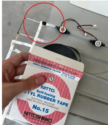
Figura 2.21 Fijación a través de cinta vulcanizable.
