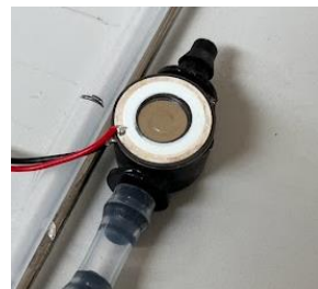
Figura 2.18 Fijación adhesiva del atomizador sobre la mini válvula a modo de cuerpo de suministro.
