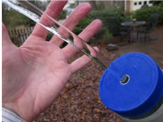
Figura 3.04: Flujo de agua en régimen laminar.
