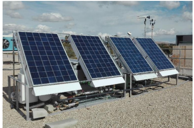
Figura 2: Instalaciones de refrigeración solar construidas por el grupo solicitante. Izquierda: Planta de absorción descrita en Martínez et al. (2012). Derecha: Instalación experimental descrita en Lucas et al. (2017).
