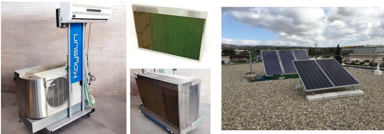
Figura 3: Izquierda, Fotografía de la instalación experimental descrita en Martínez et al. (2016), Derecha: Cubierta del edificio El Altet donde se sitúan los paneles fotovoltaicos que alimentan al prototipo actual.
